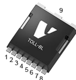
TOLL-8L 1.Gate(G) 2.3.4.5.6.7.8 Source(S) 9.Drain(D)
