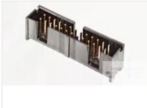
TE Part #1761681-5 IDC LOW PRO HDR 14P VERT HT BLACK
