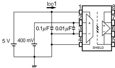
**Fig. 4 I<sub>DD2</sub> Test Circuit**
