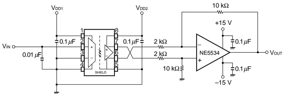
**Fig. 9 CMTI Test Circuit**
