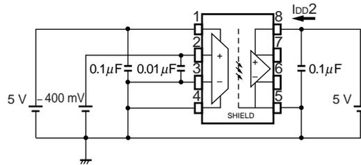
**Fig. 5  $I_{IN+}$  Test Circuit**
