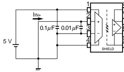
**Fig. 6  $V_{OUT}$  Test Circuit**
